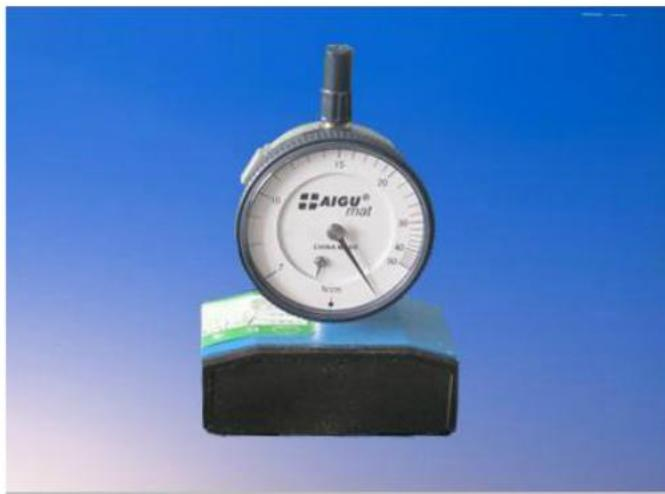
张力计出厂前已经校正零位，用户不用自行调整，拉网的张力用 N/cm, 用 N/cm, 即表示网纱在每厘米宽度有多大的张力（通常用 N·牛顿或是 Kg·公斤来表示，所以牛顿显示张力计才是有实际意义的张力计；读数显示方法：本张力计读数指针旋转刚开始第一圈的读数是不准确的，指针旋转第二圈开始才是正常读数）并要轻弹张力计旁的网纱。
