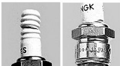
图3 火花塞头部、封压部断裂
