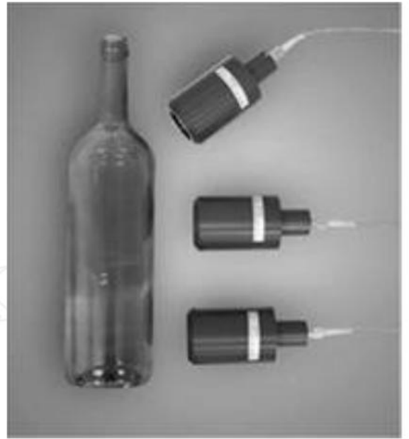
可以检测有色玻璃瓶,上图所演示的是检测玻璃瓶壁厚过程中测头的摆放安排(来自 Precitec)
